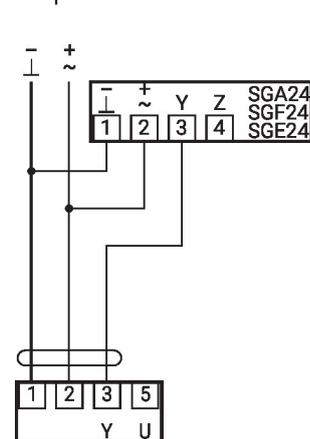
Limitation minimale avec positionneur SG.
