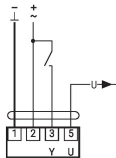
Commande forcée et limitation avec alimentation AC 24 V par un commutateur rotatif
