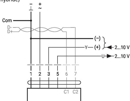
Raccordement avec capteur actif, par exemple 0 - 10 V @ 0 - 50 °C
