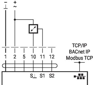
**Raccordement de contact de commutation**
