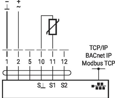
TCP/IP (Cloud) / BACnet IP / Modbus TCP avec point de consigne analogique (fonctionnement hybride)
