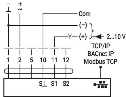
Raccordement de contact de commutation
