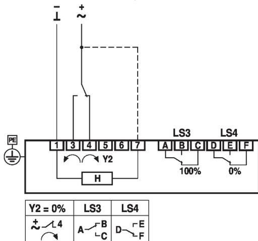
H: Chauffage interne (pas besoin de le connecter pour les applications à l'intérieure avec température constante)
