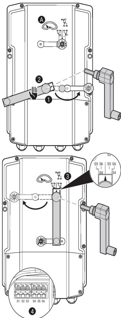
**1** Débrayage du servomoteur
