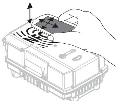
**Raccordement des outils** Le servomoteur peut être paramétré par le ZTH EU via la fiche de service.
