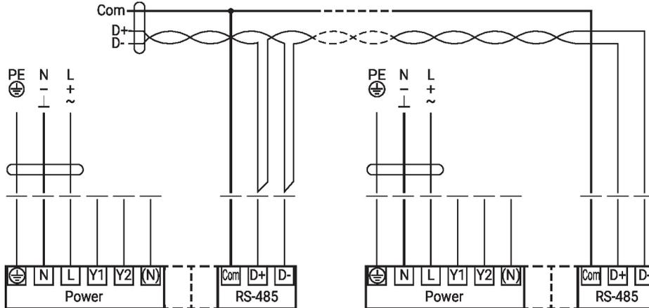
Raccordement BACnet MS/TP / Modbus RTU avec consigne analogique (mode hybride)
