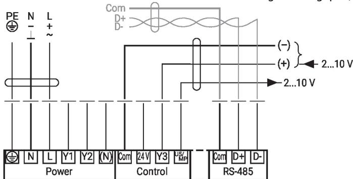
Raccordement de capteurs passifs (BACnet MS/TP / Modbus RTU)
