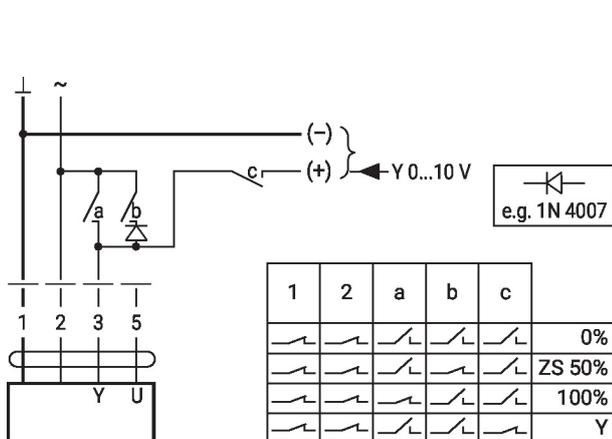
Commande forcée avec commutateur rotatif AC 24 V
