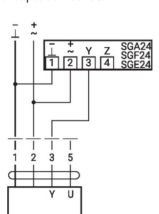
Limitation minimale avec positionneur SG.
