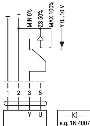
Commande à distance 0...100% avec positionneur SG.
