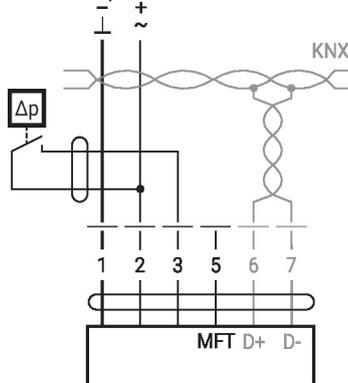
Exigences relatives au contact de commutation : le contact de commutation doit pouvoir commuter un courant de 16 mA à 24 V avec précision.
