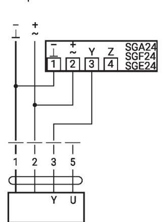
Limitation minimale avec positionneur SG.
