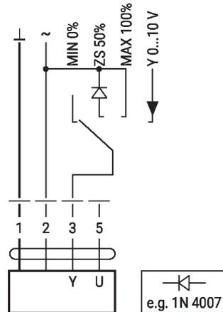
Commande à distance 0...100% avec positionneur SG.
