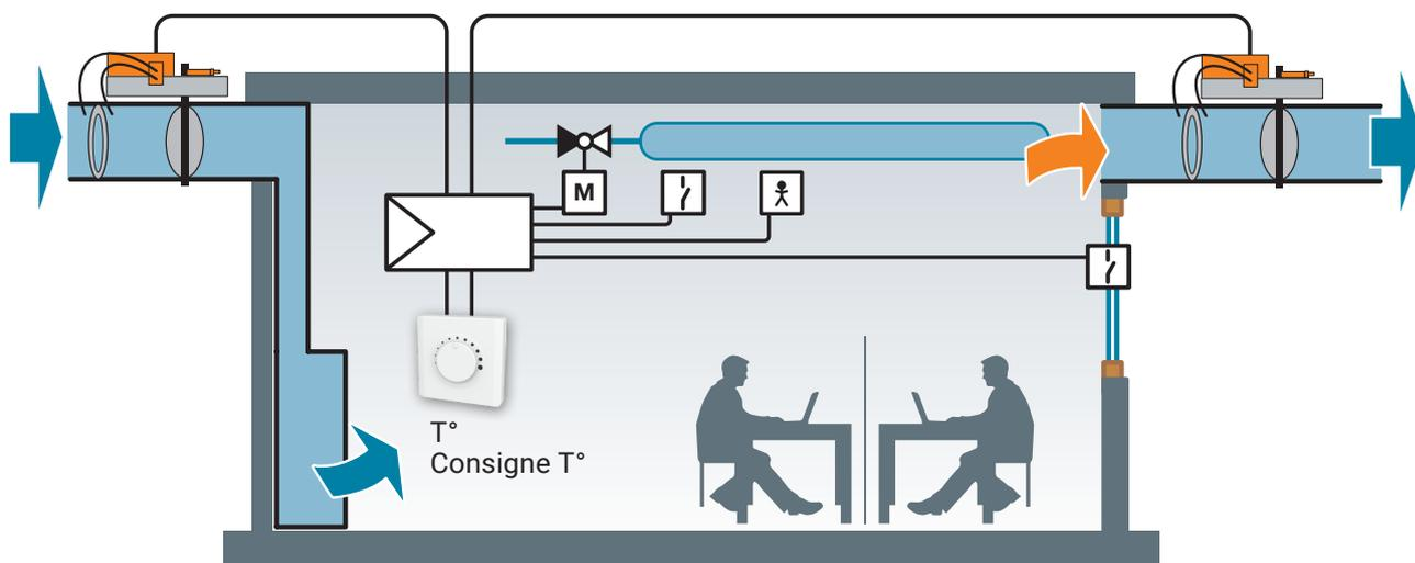
Exemple de plafond rafraîchissant avec VAV et un module d'ambiance avec capteur de température et réglage de la valeur de consigne.
