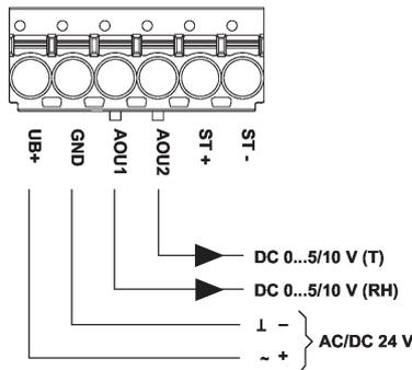
Les connecteurs ST+ / ST- sont uniquement utilisés pour les types de capteur qui disposent par ailleurs d'un élément de capteur de résistance passif pour la mesure de température.
