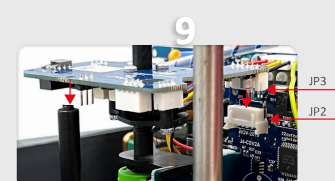
Introducir hasta que el conector de la electrónica DPS (JP3) esté conectado con el conector(JP2) de la electrónica del actuador.
