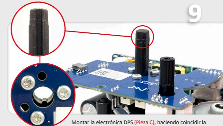
Montar la electrónica DPS (Pieza C), haciendo coincidir la hendidura del eje con la chaveta del engranaje central.
