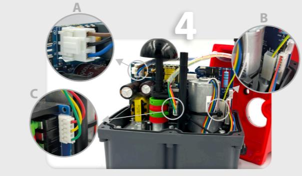
Desconectar el cableado de la tapa que está conectado a la electrónica. (Fig. A, B y C).
