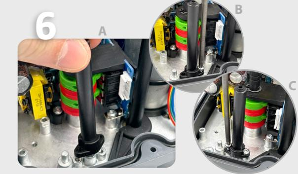
Fijar la columna de plástico (Pieza B) a la chapa del actuador, mediante 2 tornillos rosca chapa (Pieza D). (Fig. A, B y C).
