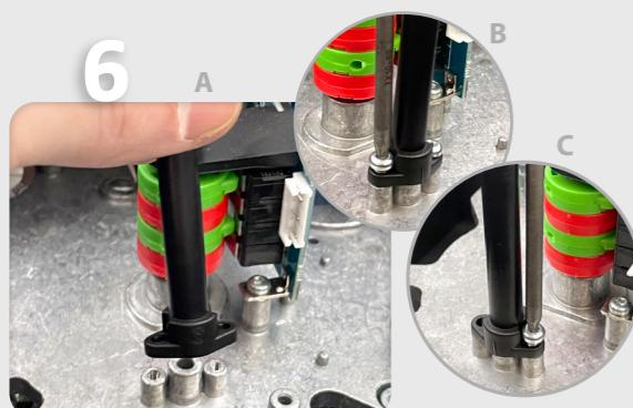
Fijar la columna de plástico (Pieza B) a la chapa del actuador (Fig. 7A) mediante 2 tornillos rosca chapa (Pieza D) (Fig. 7B y 7C).
