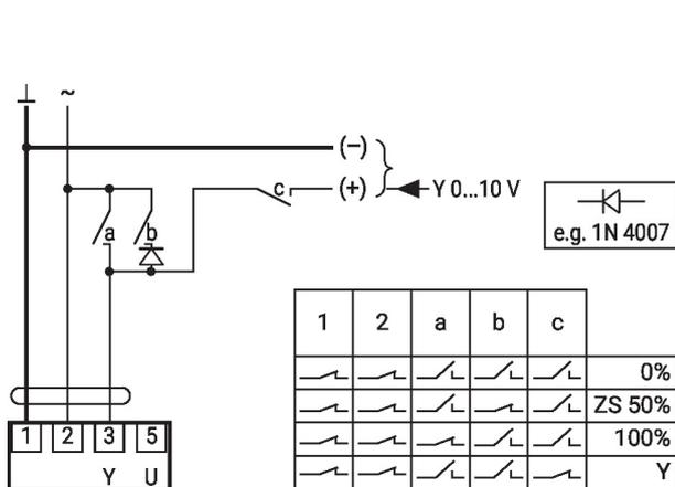
Zwangssteuerung mit AC 24 V mit Drehschalter
