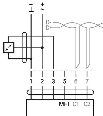
Möglicher Eingangsspannungsbereich: 0...10 V
