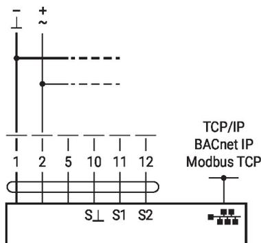
TCP/IP (Cloud) / BACnet IP / Modbus TCP mit analogem Sollwert (Hybridbetrieb)
