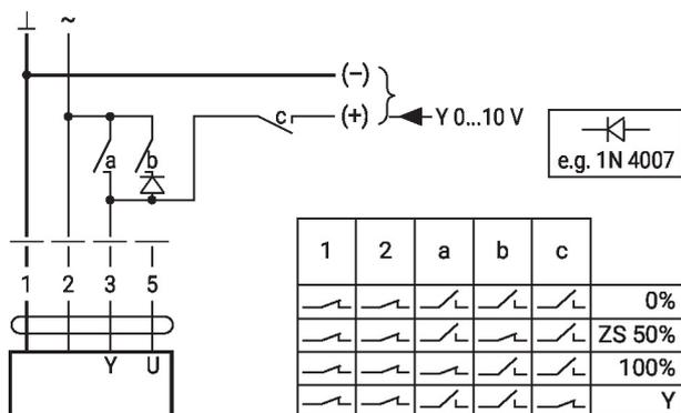
Zwangssteuerung mit AC 24 V mit Drehschalter
