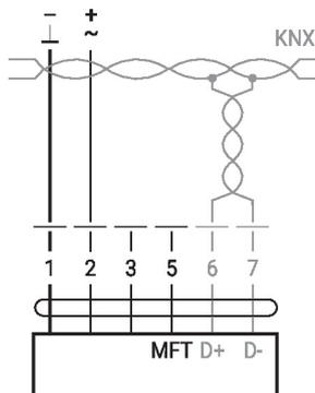
Anschluss mit passivem Sensor, z.B. Pt1000, Ni1000, NTC
