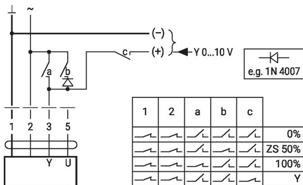
Zwangssteuerung mit AC 24 V mit Drehschalter
