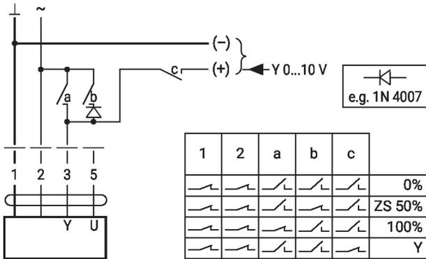
Zwangssteuerung mit AC 24 V mit Drehschalter
