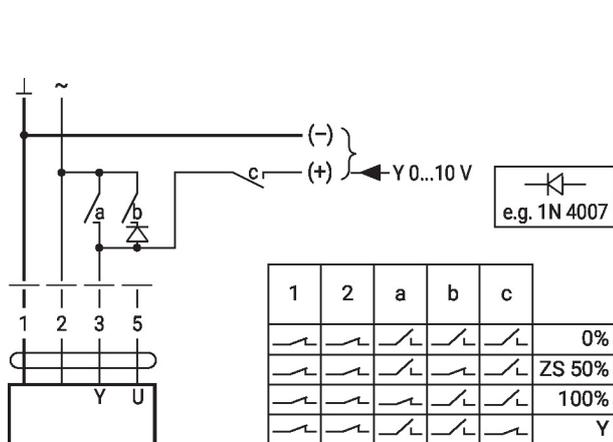
Zwangssteuerung mit AC 24 V mit Drehschalter
