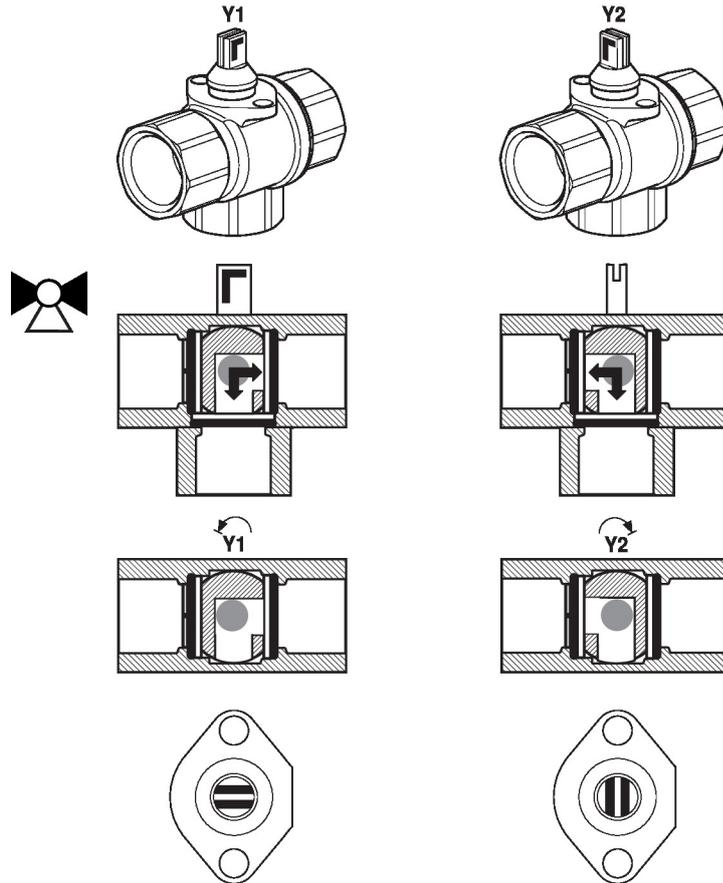
**Durchflusseinstellung** Beim Antrieb ist der Endanschlag-Clip zu entfernen, um den für die Umschaltfunktion notwendigen Drehwinkel von 90° zu erhalten.
