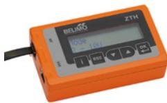
Service-Tool für parametrierbare und kommunikative Belimo-Antriebe / VAV-Regler und HLK-Stellgeräte. Das ZTH EU wird beim Verbinden auf die Servicebuchse vom MP-Knoten gespeist.
