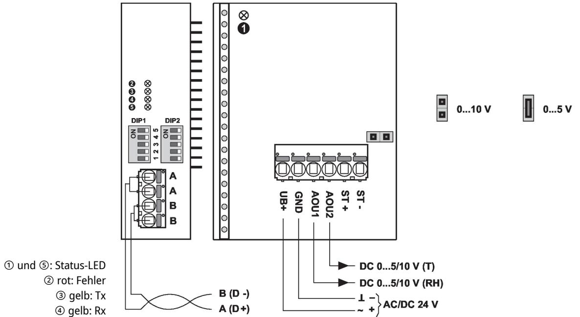
Anschlussstecker ST+ / ST- sind nur für Sensortypen zu verwenden, die zusätzlich über ein passives Widerstands-Sensorelement für Temperaturmessungen verfügen. Die Einstellung der Messbereiche erfolgt durch Änderung der Bonding-Jumper. Der Ausgangswert im neuen Messbereich ist nach 2 Sekunden verfügbar.
