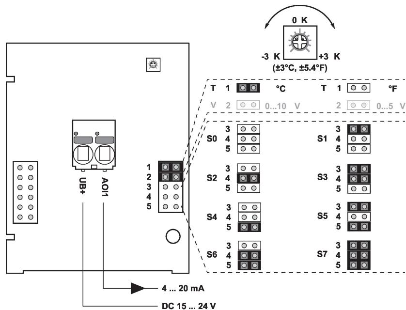
Die Einstellung der Messbereiche erfolgt durch Änderung der Bonding-Jumper.
